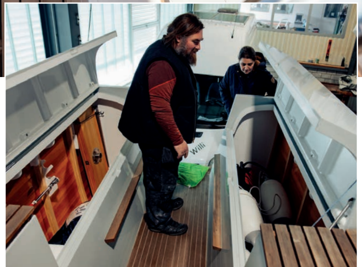
Innen zeigt sich das Holz in den Backskisten, außen sorgt eine Glasfaserbeschichtung für zusätzlichen Schutz des Rumpfs. Foto: Julius Osner ↑
