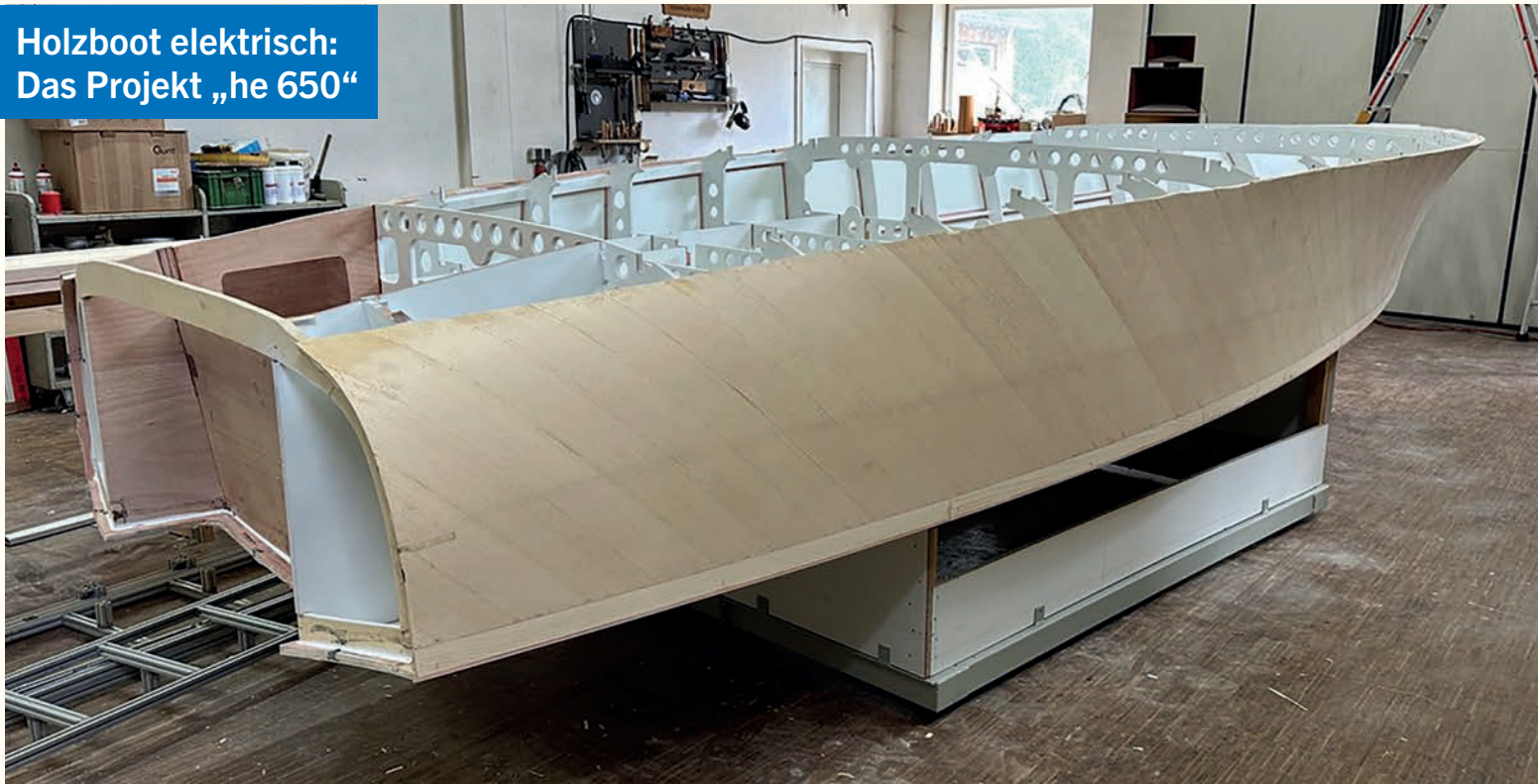
↑ Das Projekt „he 650“ – Verwendung heimischer Hölzer im konsequent gewichtsoptimierten Leichtbaukonzept des E-Bootes. Foto: Juliane Hempel
