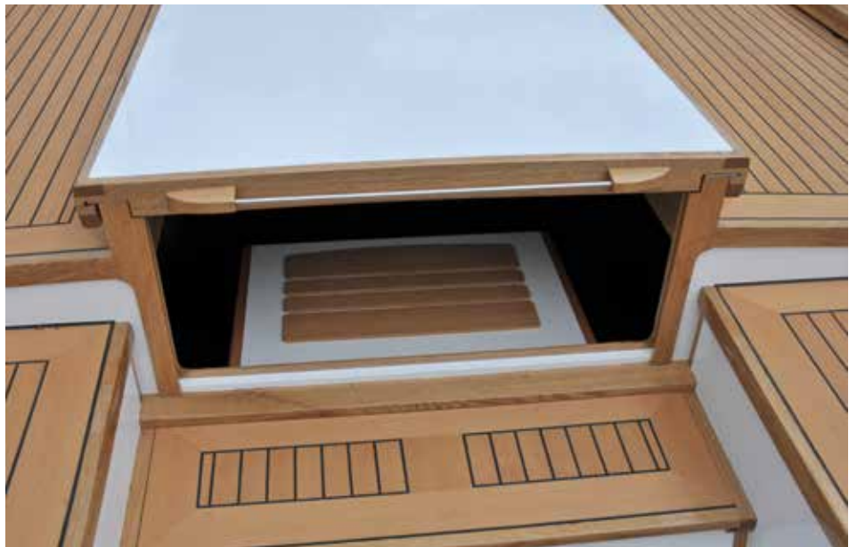
Niedergang mit großem Schiebeluk
