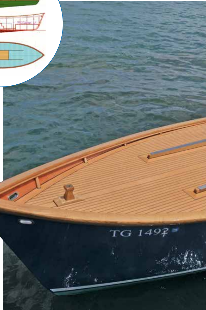
Das Deck ist frei von Beschlügen, und im Gegensatz zu den Originalen, die gewölbte
