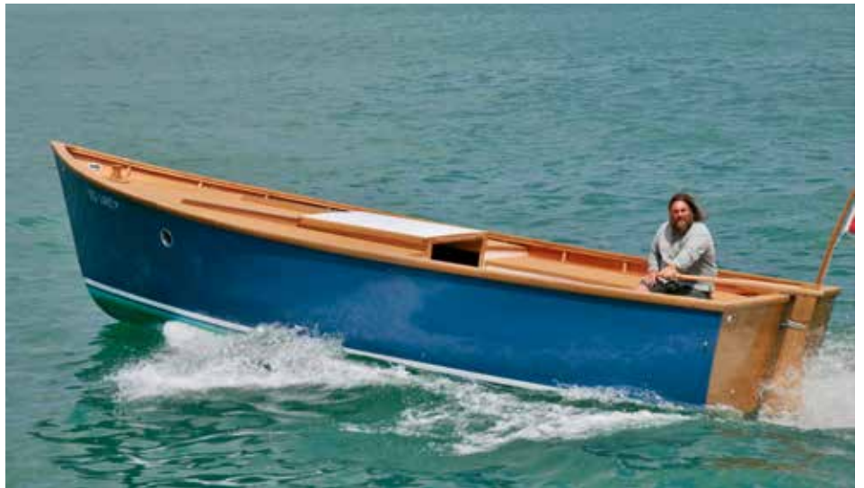
Die Gozzo in Halbgleiterfahrt, Höchstgeschwindigkeit fast 20 km/h
