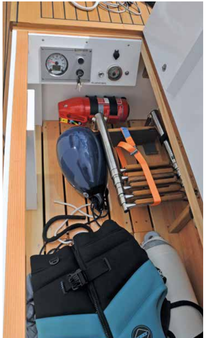
Es gibt zwei Backskisten – steuerbordseitig ist das Motorpaneel eingebaut.
