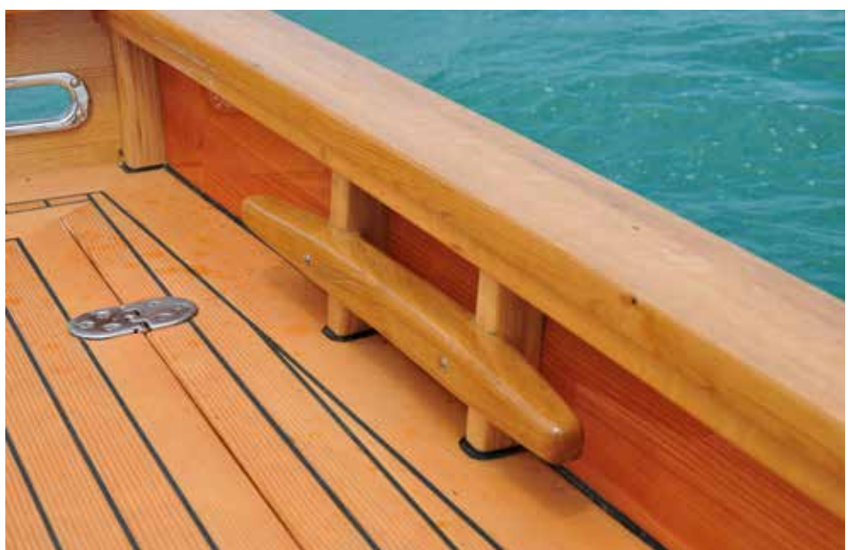
Klampe aus Holz, so montiert, dass sie nicht stört.
