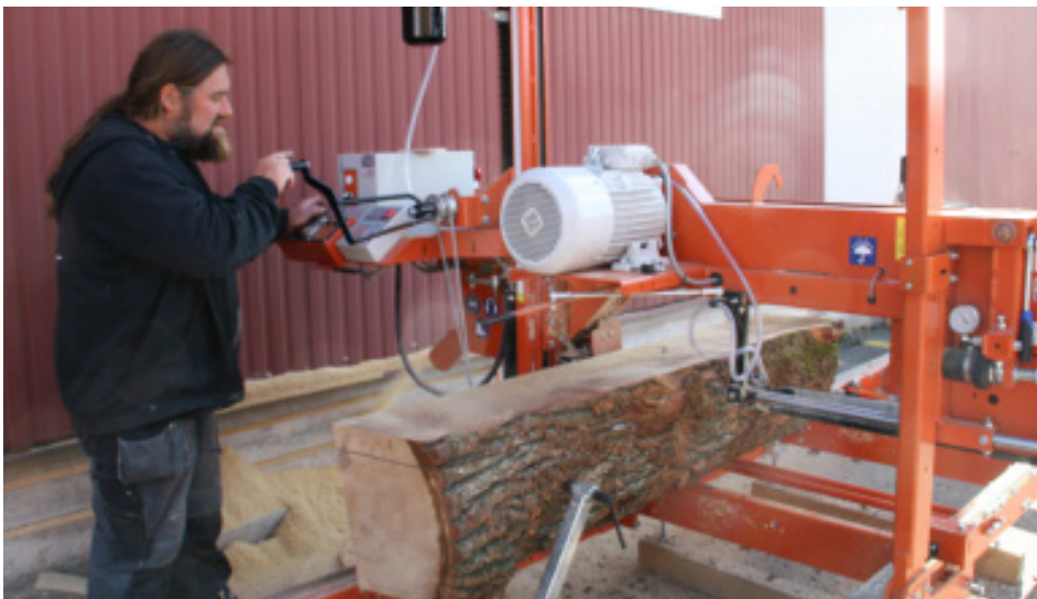
Auf der Blockbandsäge kann Züst seine Blockware selbst aus bis zu 15 Meter langen Stämmen herstellen.
