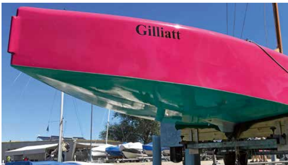
Die Heckpartie mit der geringen Aufkimmung. Für den Anschlag ist das Ruderblatt ausgeklinkt und dadurch leicht vorbalanciert.
