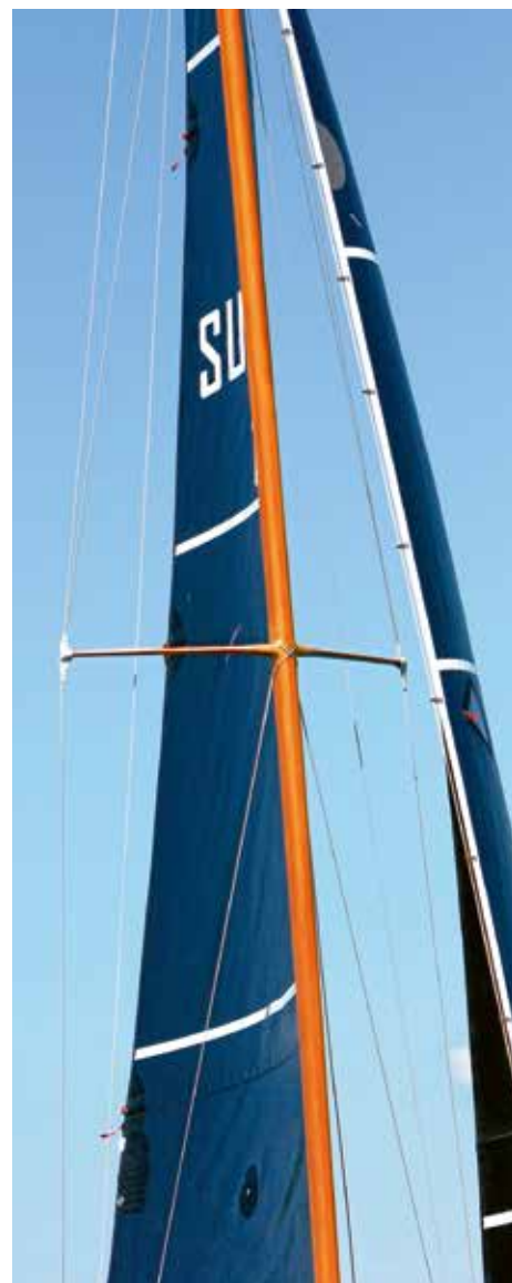
Die Salingsprofile sind fest am Mast anlaminiert und halten gleichzeitig die Unterwanten.
