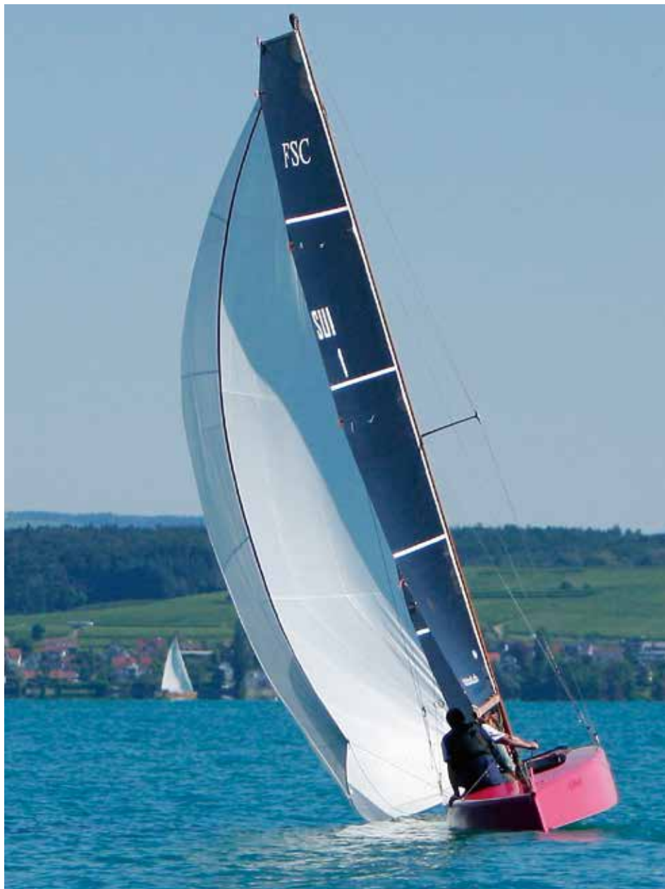
Wird das Boot auf der Kimm gefahren, hebt sich fast die gesamte Luvseite des Unterwasserschiffs über das Wasser.
