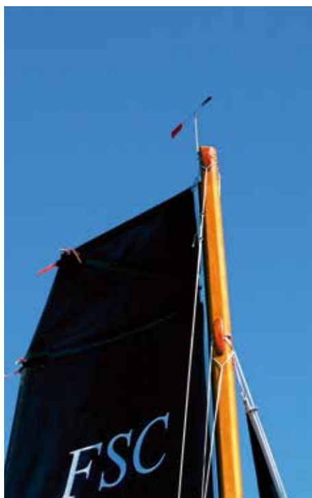
Tradition trifft Moderne: Das stehende Gut ist für optimale Krafteinleitung um den Mast geschlungen.
