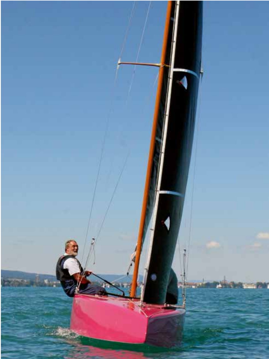
Auch hier ist der flache Boden gut zu erkennen. Die Luvkimm liegt etwas über die Wasserlinie.
