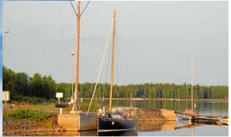
Die in Holz gebaute Alzira ist ein neun Meter langer und 2,50 m breiter moderner und schneller Gaffelkutter. Besegelung am Wind fast 80 Quadratmeter.
