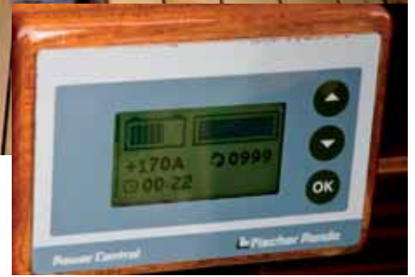
1 + 2: Die Mittelkabine mit zwei Längskojen. Darunter sind die Batterien und Steuertechnik sowie Stauraum. 3 Das noch nicht ausgebaute Vorschiff. Im Bug der Landanschluss und der Tank. 4 Statusanzeige mit Stromaufnahme bei Vollast und Propellerhöchstzahl (999 U/min).
